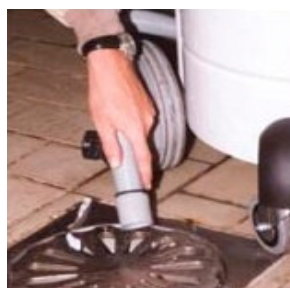
Tuyau de vidange pour évacuation des liquides
